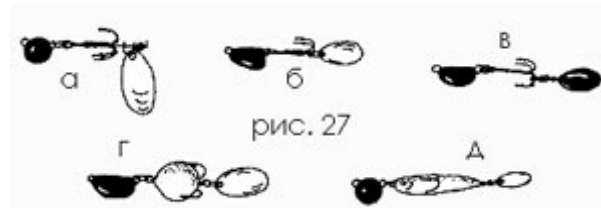
Рис. 27. Самодельные тейл-спиннеры: а) с несъемным лепестком; б), в) с заменяемым лепестком на вертлюжке; г) с противозацепным поролоновым шариком; д) спандж-спиннер
